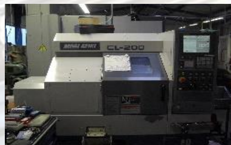
CNC Drehmaschine Mori Seiki CL-200A 10fach Werkzeugwechsler Spindel durchlass von 51mm
