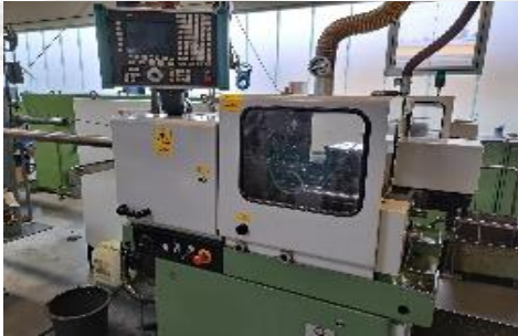
TRAUB Drehautomaten mit 3m Stangenvorschub 3x Durchlass: 26mm, davon 1 x CNC 1x Durchlass: 42mm
