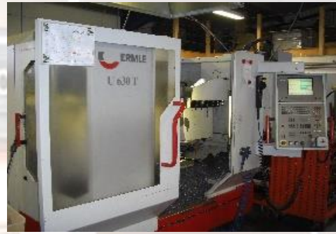
CNC Bearbeitungszentrum HERMLE U630T 16fach Werkzeugwechsler Spannfläche: 980mm x 600mm Bearbeitungsfläche: X = 650mm Y = 450mm Z = 450mm
