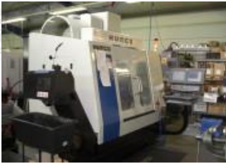
Vertikal Bearbeitungszentrum HURCO VMX30t 24fach Werkzeugwechsler Spannfläche: 1020mm x 510mm Bearbeitungsfläche: X = 760mm Y = 510mm Z = 610mm
