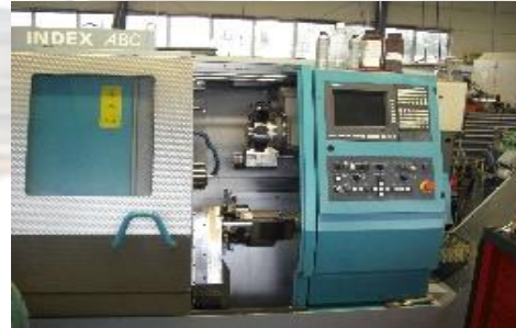
INDEX ABC Speedline Spindeldurchlass von 50mm Gegenspindel
