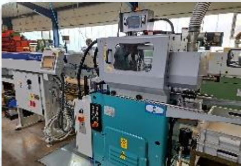
Drehautomat CE-Ausführung (2 Stück) Wachtler A GLE CNC mit 3m Stangenvorschub Spindeldurchlass von 15mm
