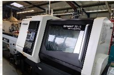
Langdrehautomat mit 5 Linearachsen SPRINT20/5 23fach Werkzeugwechsler Spindeldrucklass von 20mm
