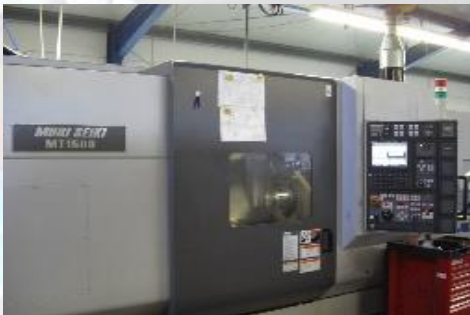
CNC Drehmaschine Mori Seiki MT 1500 SZ 20fach Werkzeugwechsler für Fräseinheit Haupt- und Gegenspindel, 12-fach Revolver Außendurchmesser max. 250mm
