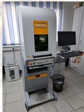
Lasermarkiersystem BIG SMARK 200F EP Laserleistung: 20 W maximale Werkstückabmessungen: 495 mm x 495 mm x 338 mm Optisches Markierfeld: 180 mm x 180 mm
