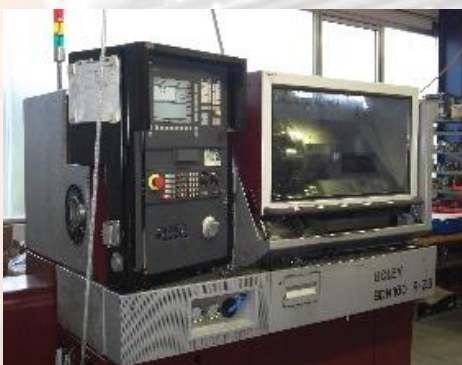
CNC Drehmaschine Boley BDN160 RZB42 16fach Werkzeugwechsler Spindel durchlass von 42mm Drehlänge: 115mm Angetriebene Werkzeuge 16 Abgreifspindel für Rückseitenbearbeitung
